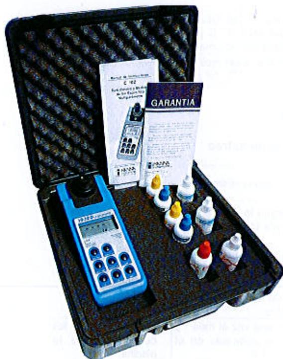
El HS93102C realiza mediciones de turbidez mediante el principio nefelométrico de acuerdo con el método USEPA 180.1 , el recomendado para rangos bajos de medición.
